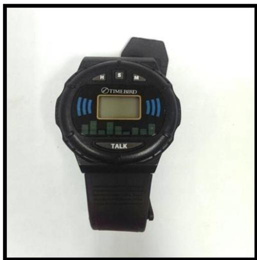
以液晶螢幕顯示時間數字，電子語音報時，有整點語音報時、鬧鈴設定等功能，屬於溝通與資訊輔具中《警示、指示與信號》輔具的一種。
