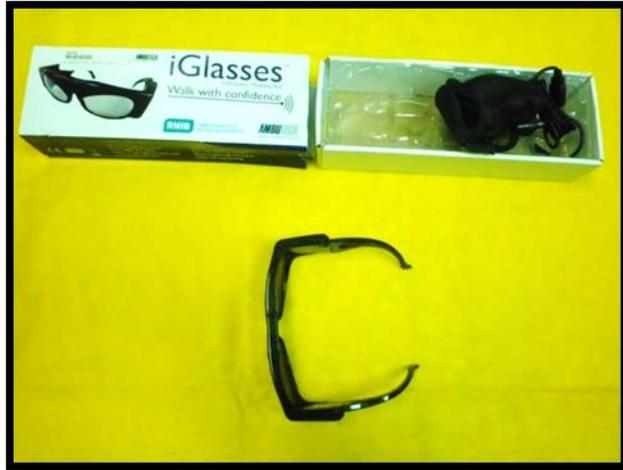
具有超音波感應功能，越接近前方障礙物，震動頻率越高，反之則減少
