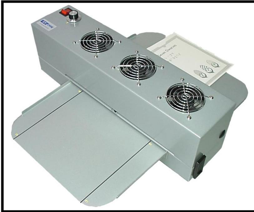
能夠將紙張上之圖案，經加熱後印製成立體。將圖案先行印在特殊的紙上，再經由立體影印機加熱，可以使圖案具碳粉的部分突起，適用於視覺障礙者，可以使他們摸出圖案大概的輪廓
